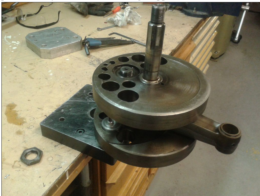
Vevaxel med borrade balanseringshål från Vincent Comet
