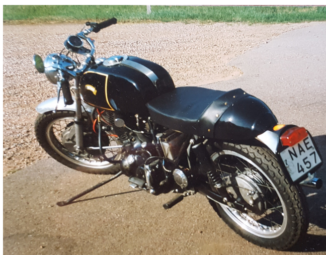
Eglin i ett testutförande under en sommar, med alu-tank och egentillverkad sadel o skärm.
