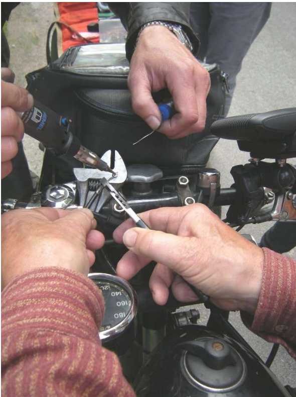
Jimmy C fick lite problem med en trilskande gasvajer men den reparerades med en fiffig gasol-driven lödpenna som hjälp. Mikael A assisterar.
