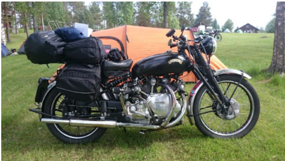
Börjes maskin med jättepäckning och GPS. Notera fjädring från off-roadhoj.
