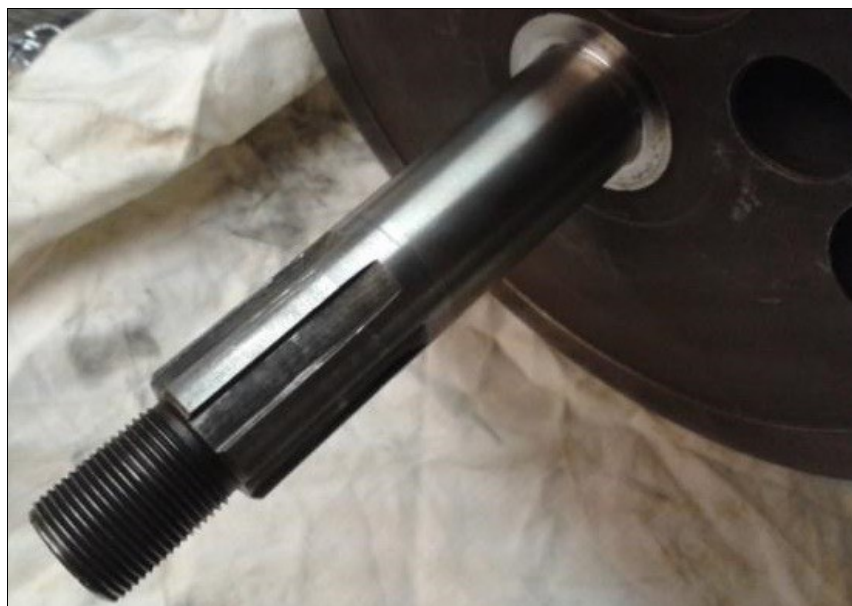
Den metallsprutade och slipade axeltappen.
