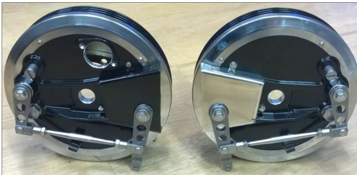
Dubbelnockad broms från Nederländerna, 7 tum diameter
